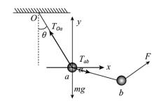
在(1)问中可求得绳子Oa上的拉力为  $T_{Oa} = 2mg \cos 30^{\circ} = \sqrt{3}mg$  ③
